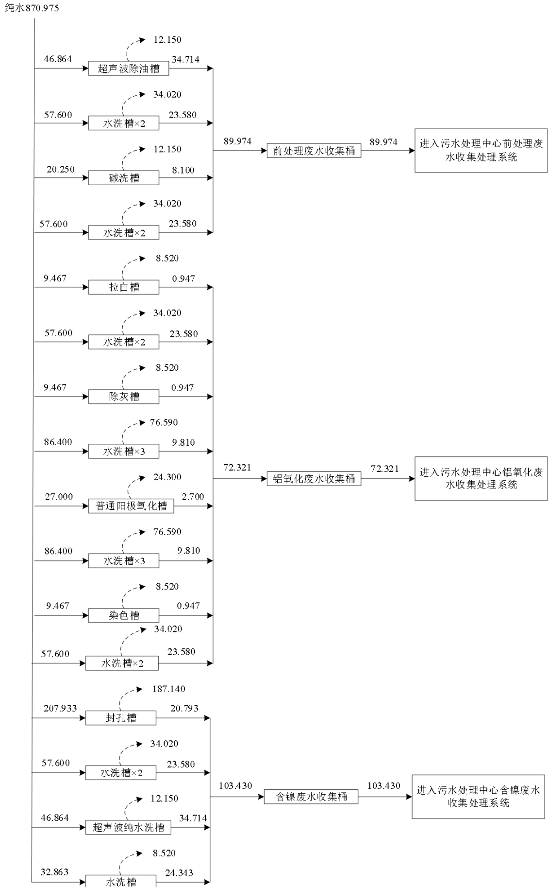
图 3.3.6-2 项目 1 号阳极氧化生产线零散件生产水平衡图 (m³/a)
