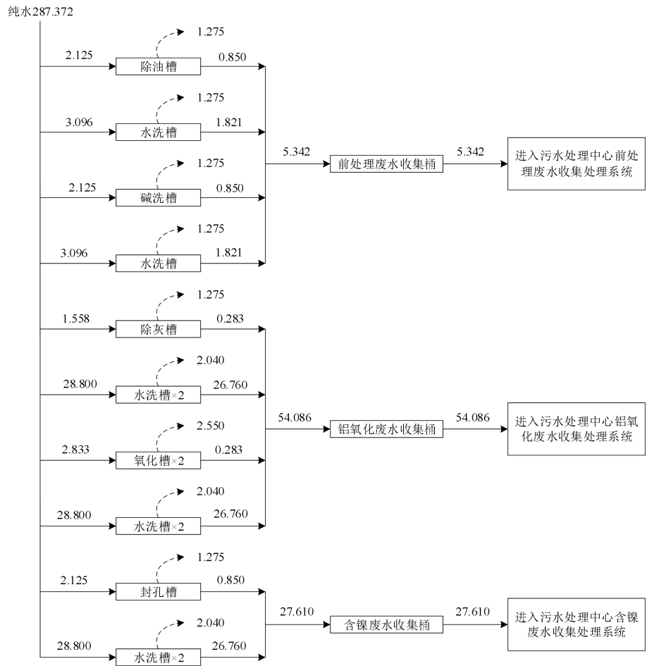
图 3.3.6-9 阳极氧化打样线水平衡图 (m³/a)
