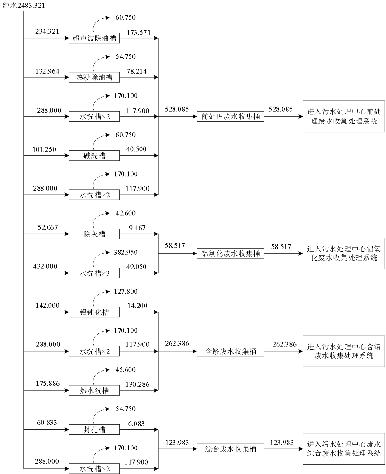
图 3.3.6-4 项目 3 号铝钝化生产线水平衡图 (m³/a)
